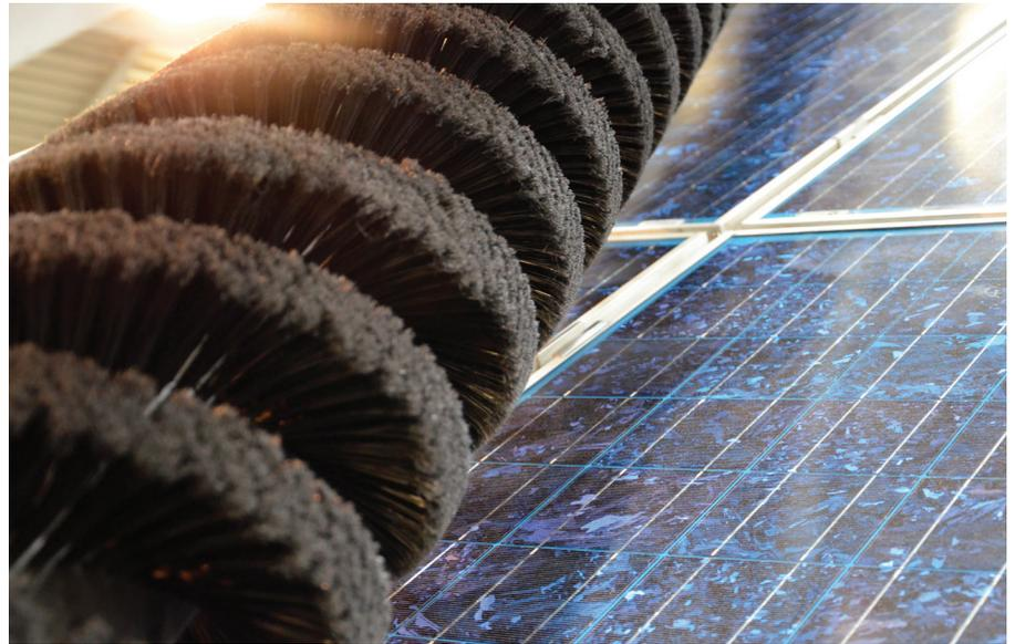
Abb. 6: Reinigung einer PV-Anlage mit einer Bürstenwalze
