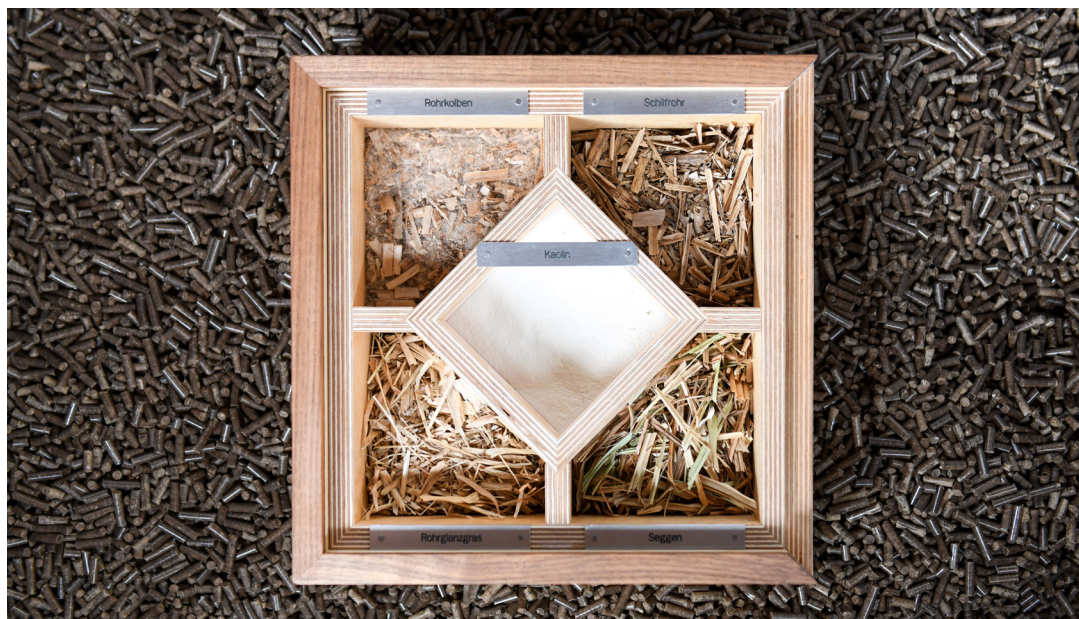
Gehäckselte Paludikulturen mit Kaolin sind die Grundbestandteile von Paludipellets.
