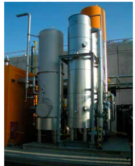
Abbildung 6: Druckwechseladsorption bzw. PSA (Pressure Swing Adsorption)
