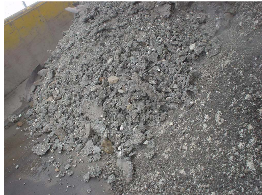
Schlackenbildung im Brennraum, Ascheklumpen
