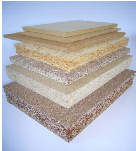
Leichte Holzwerkstoffe 300-500 kg/m 3
