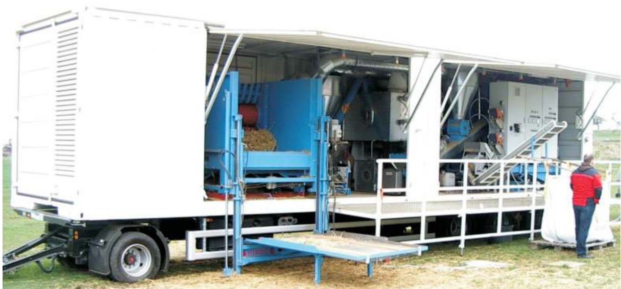
Abbildung 1: Mobile Pelletiereinheit zur Pelletierung von Halmgütern der Firma BauerPower (Bildquelle: www.energievomland.de , Stand 09/2010)
