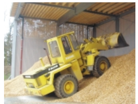
Befüllung des Hackschnitzelbunkers
